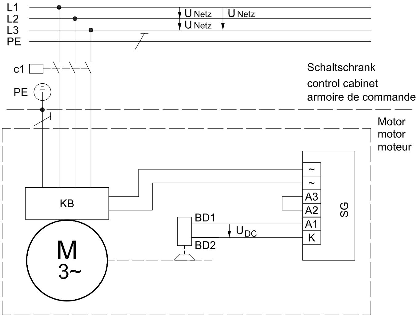
Anschluss am Klemmenbrett KB in Abhängigkeit von der DC-Bemessungsspannung der Bremse  $U_{DC}$
