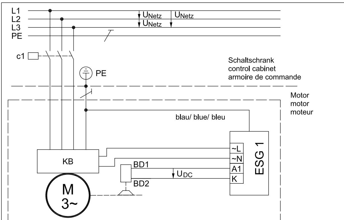
Anschluss am Klemmenbrett KB in Abhängigkeit von der DC-Bemessungsspannung der Bremse U<sub>DC</sub>
