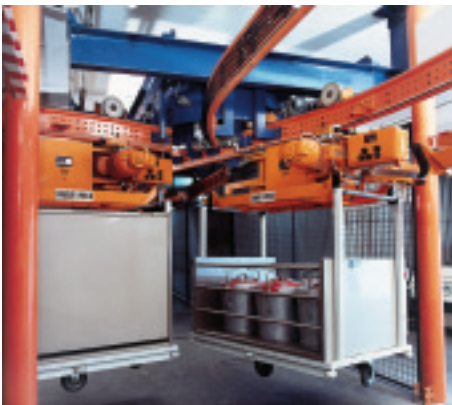
Bild 48.2 Elektro-Hängebahn (EHB) mit 1 : 4 polumschaltbaren Getriebemotoren (Hersteller : TRANSLIFT WHYLEN)
