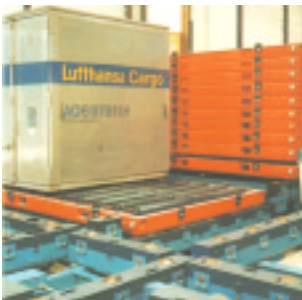
Bild 32.2 Drehtisch in einer SCHENCK-Transportanlage der Luft- hansa mit Antrieb durch Getriebe-Bremsmotor als Bei- spiel für die moderne Lösung mit elektrischem Antrieb
