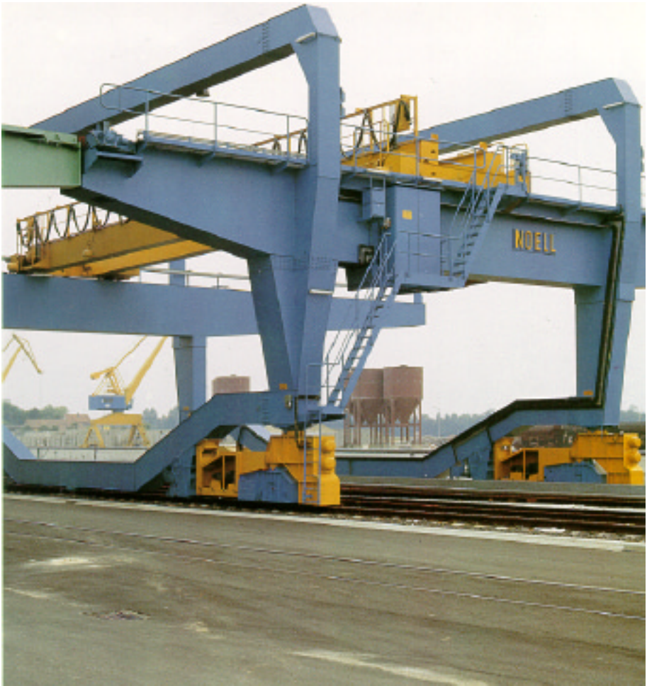
Bild 31.4 Großer Portalkran als Beispiel für den dominierenden Anteil linear bewegter Massen für die Belastung der Kranfahrantriebe
