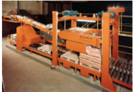
Bild 48.3 Palettierautomat für Zementsäcke Kegelrad-Getriebemotoren mit Zwangssynchronisation der vier Antriebsstationen; polumschaltbar 1 : 6 (Hersteller: BEUMER)
