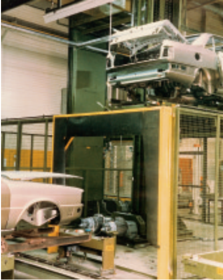
Bild 48.1 Vertikalförderer für Pkw-Aufbauten Motor polumschaltbar 1 : 6; mit Federdruckbremse und (abgedecktem) Vierkant-Wellenende zum Einrichten; Reserve-Antrieb vorbereitet (Hersteller: STOTZ KRÄMER GmbH)
