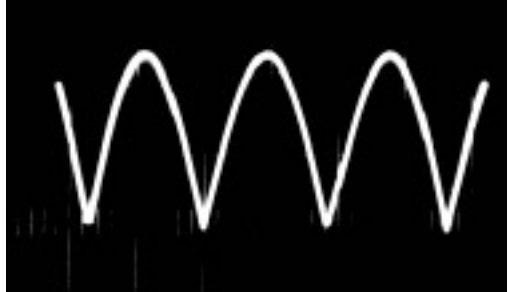
Bild 36.8.3.1.2 Oszillogramm der Leerlauf-Gleichspannung einer Einphasen-Brückenschaltung
