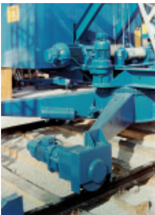
Bild 32.3 Getriebe-Bremsmotoren an Hubwerk, Drehwerk und Fahrwerk eines Turmdrehkrans
