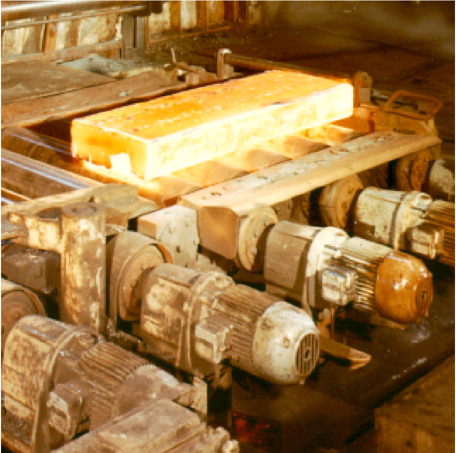
Bild 21.3 Anwendungsbeispiel für die Gegendrehabfeldbremsung im Rollgangsbetrieb
