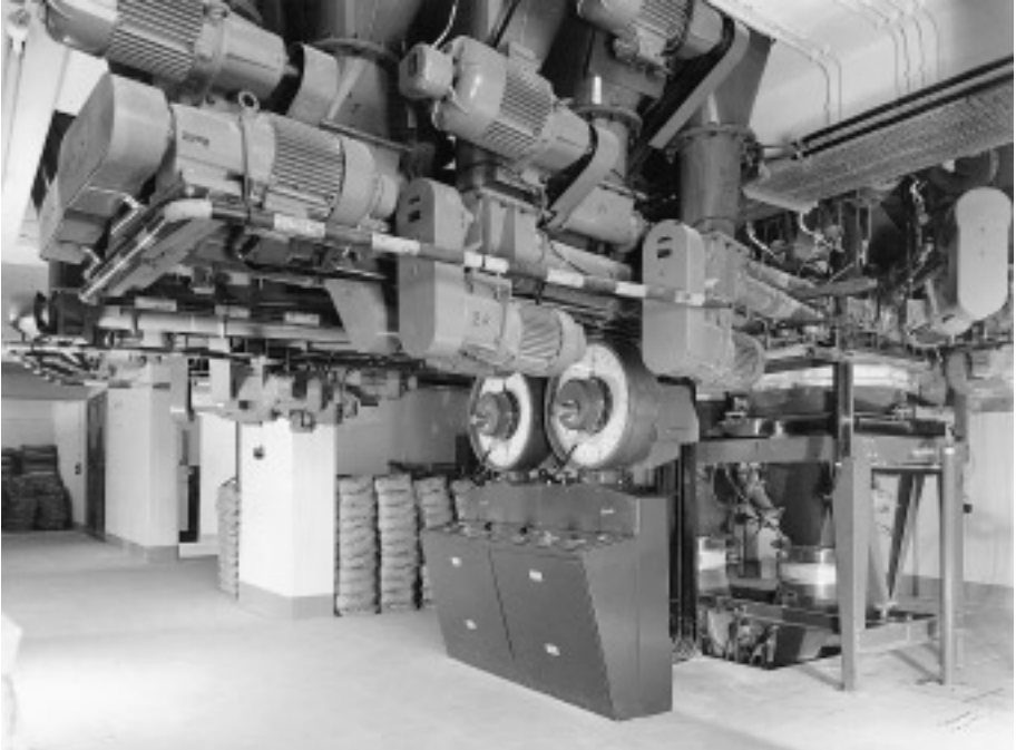
Bild 44.3 Dosierschnecken mit Füll- und Feingang; Reibungsbremsen mit kurzer Nachlaufzeit verhindern unnötige Überfüllung
