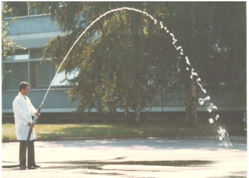
Bild 8.2.2 Prüfeinrichtung für die Wasserschutzgrad IPX5 "Strahlwasser"
