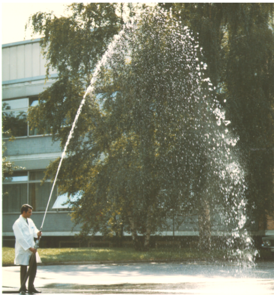
Bild 9.2.1 Prüfeinrichtung für den Wasserschutzgrad IPX6 "Starkes Strahlwasser"
