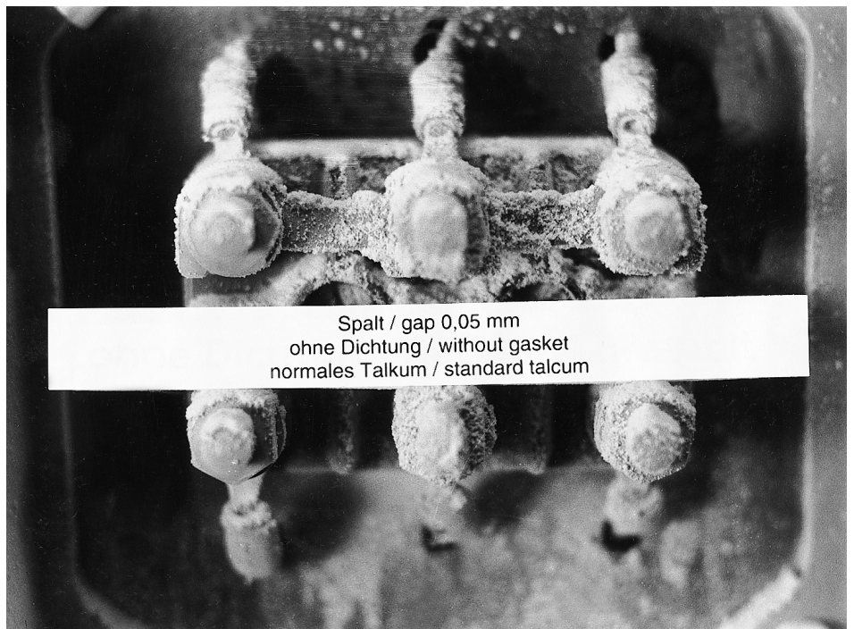
Bild 11.2.2 Versuchsergebnis mit normalem Talkumpuder (Korngrösse 0,025 bis 0,075 mm).
