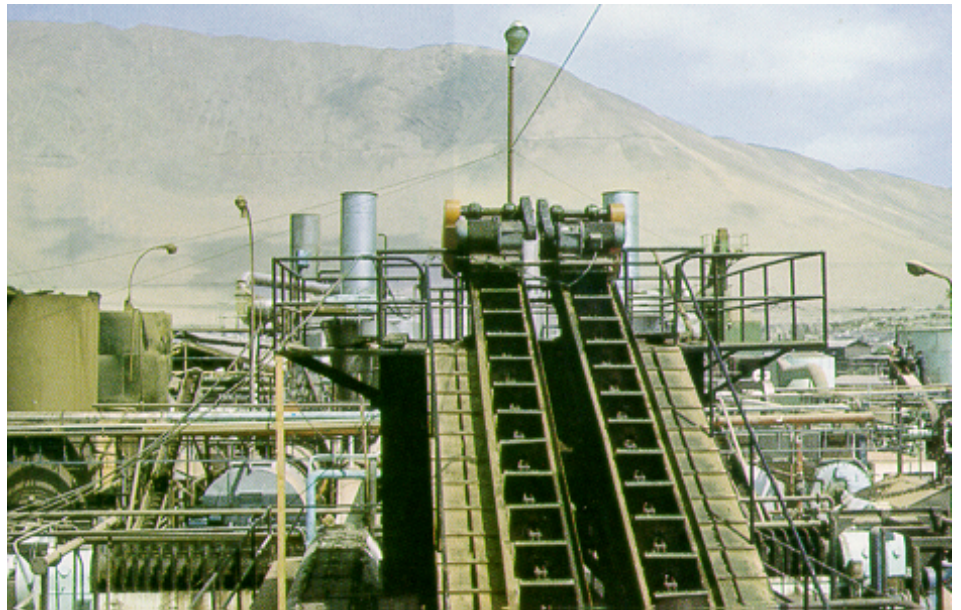
Bild 26.34 Antriebe für Steil- Förderbänder in trockener, staubiger Atmosphäre.
