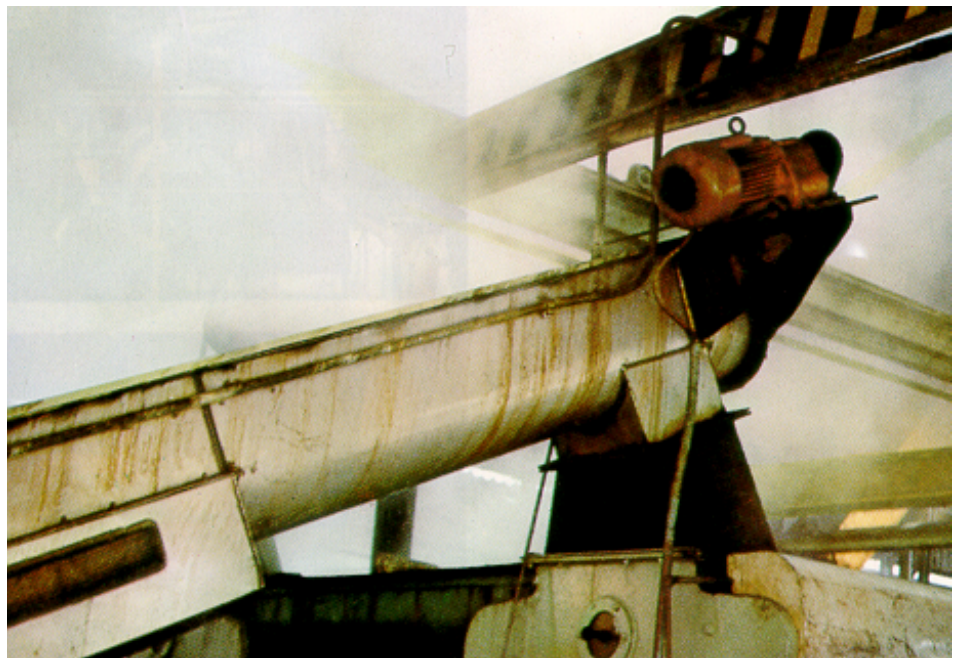
Bild 26.37 Antrieb einer Förderschnecke in aggressiver Atmosphäre.
