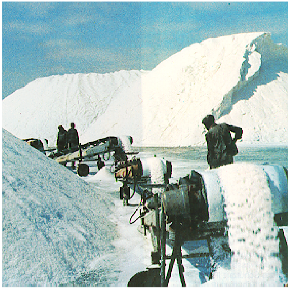
Bild 14.2.2 Förderlinie aus fahrbaren Gurtförderern mit Trommel-Motoren bei der Salzgewinnung in einem tropischen Gebiet
