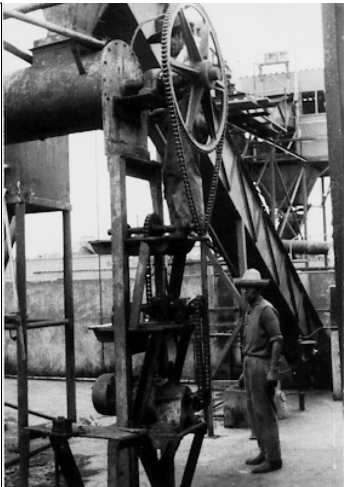
Bild 12.2.3 Offenes Kettenvorgelege an einem Getriebe-Motor in einer Fischmehlfabrik in Peru
