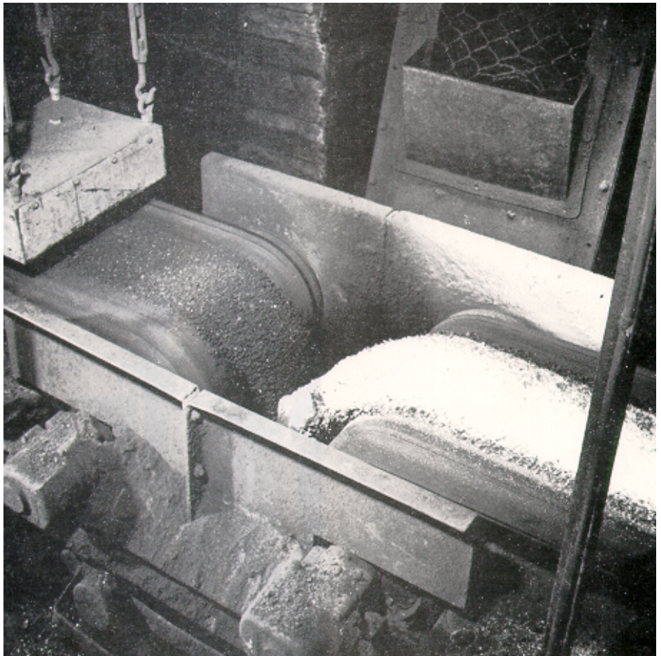
Bild 26.20 Drehstrom-Trommel- Motoren zum Antrieb von Förderbändern für die Mischung von Erz und Salz in einer Kupferhütte.
