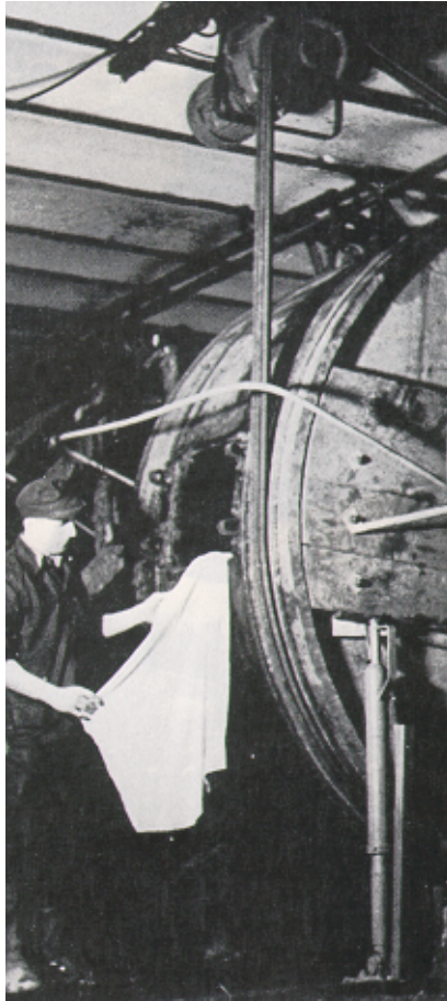
Bild 26.18 Drehstrom-Stirnrad- Getriebe-motor zum Antrieb eines Gerbfasses in feuchter und sehr aggressiver Atmosphäre.
