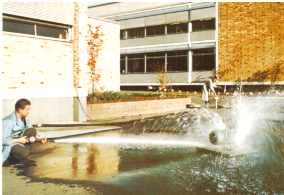
Bild 9.3.6 Verschärfte Prüfung von Motoren der Sonderschutzart IP66 mit einem Wasserstrahl aus einem Strahrohr mit 25 mm Durchmesser und einem Wasserdruck entsprechend einer Steighöhe von 8 m
