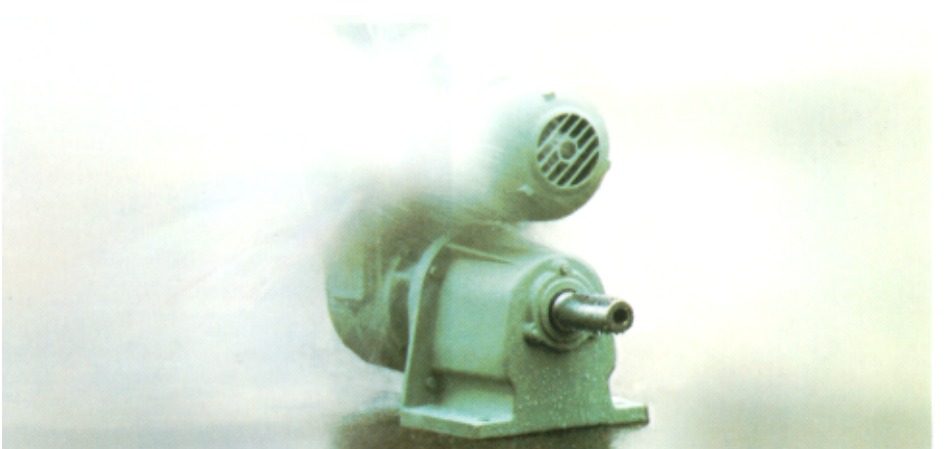
Bild 8.2.4 Wassereinwirkung bei der Strahlwasserprüfung IPX6 »Starkes Strahlwasser«
