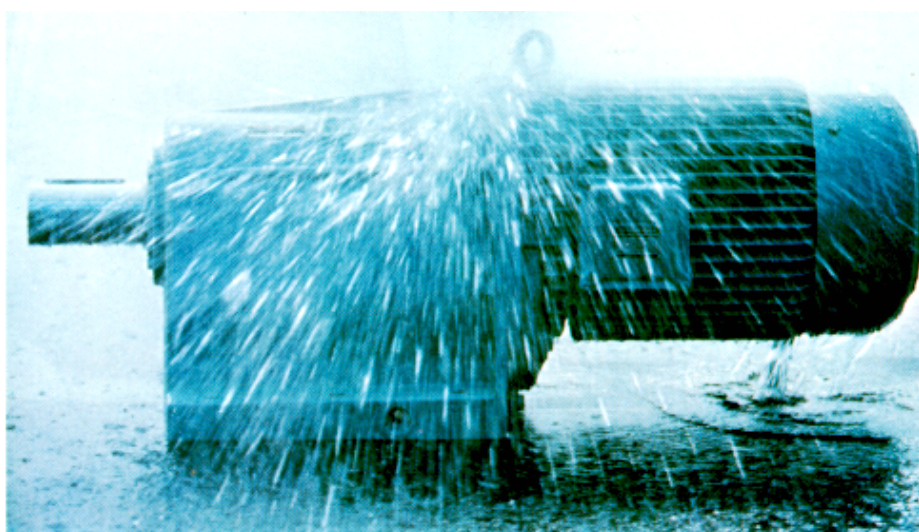
Bild 9.2.2 Wassereinwirkung bei starker Strahlwasserprüfung IPX6
