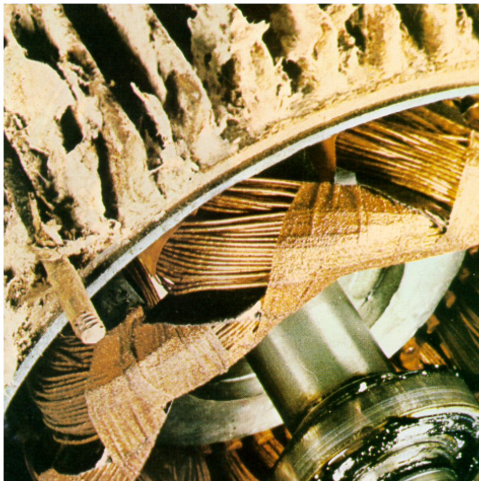
Bild 26.1 Ständer eines Getriebe- Motors in Schutzart IP65 nach jahrelangem Betrieb unter starken chemischen Einflüssen. Gehäuse zeigt äusserlich starke Angriffe, während die Wicklung noch den vollen Isolationswert aufweist.
