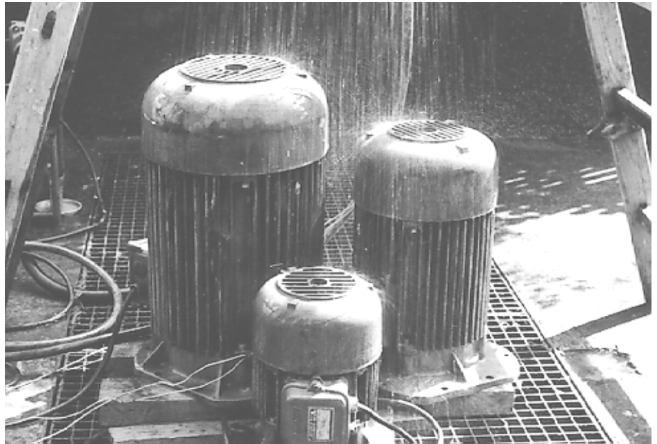
Bild 23.1 Langzeitberegnung von Getriebemotoren zur Prüfung auf Aufstellbarkeit im Freien
