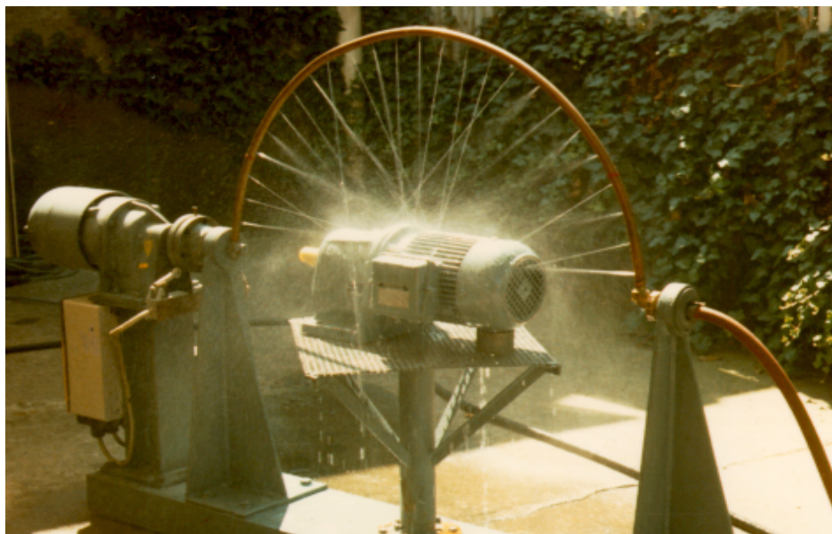
Bild 8.1.1.2 Prüfung auf »Spritzwasserschutz« mit dem Schwenkbogen
