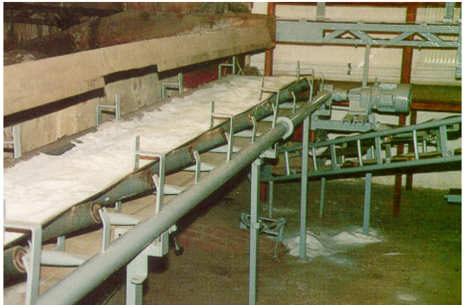
Bild 26.38 Sammelband für Salz hinter einer Siedepfanne.
