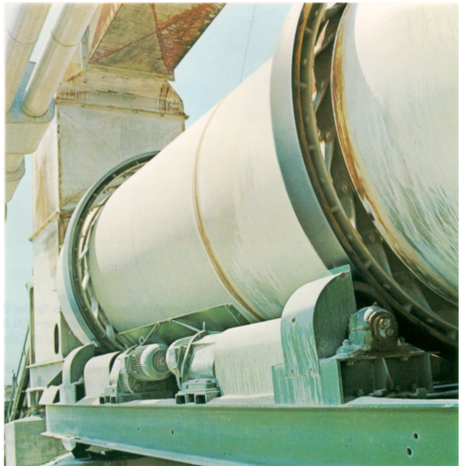
Bild 1.1 Direkter Antrieb einer Trockentrommel durch Stirnrad-Getriebemotor
