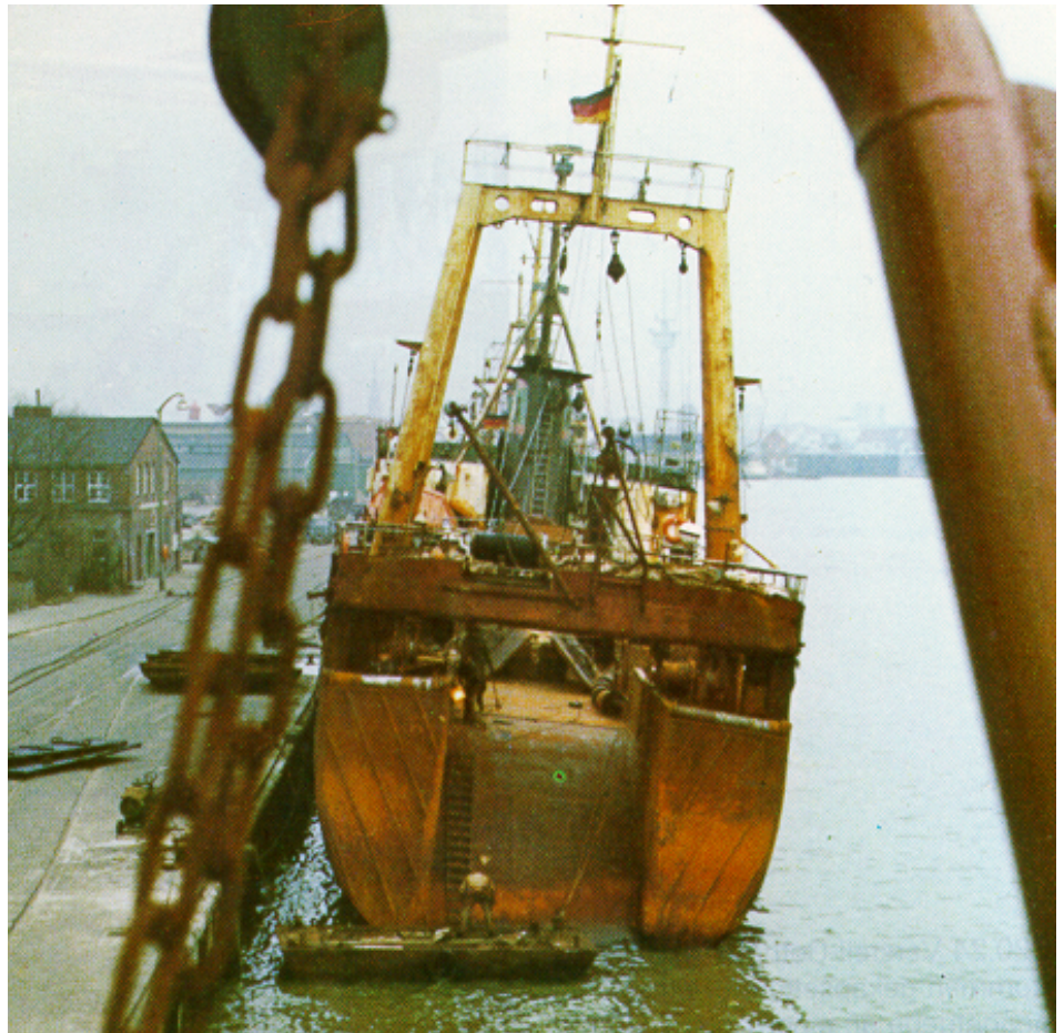
Bild 26.21 Fangschiff mit starker äusserer Rostbildung nach einer Fangfahrt von einigen Monaten.
