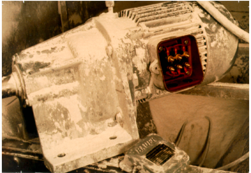
Bild 10.2.1 Drehstrom-Stirnrad-Getriebe-Motor nach einer Staubschutzprüfung. Klemmenkastendichtung mit gefetteter Kordel. Ergebnis: Kein Staubdurchtritt!
