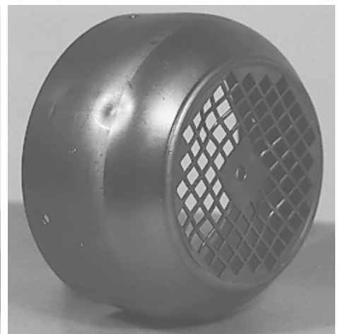
Bild 20.3 Verstärkte Lüfterhaube (1,5 mm) nach der Stossprüfung
