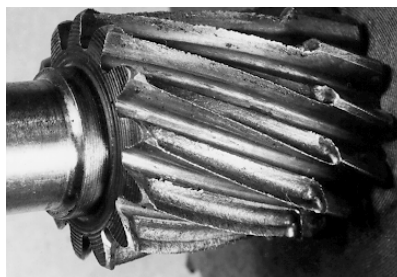
Silikonfett ohne Druckaufnahme Extremer Zahnverschleiß
