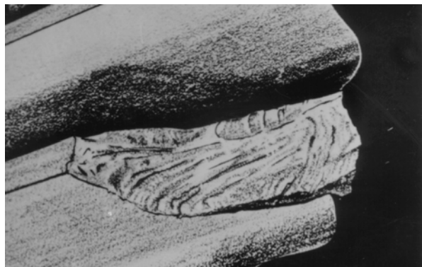
Gewaltbruch (Overload breakage)
