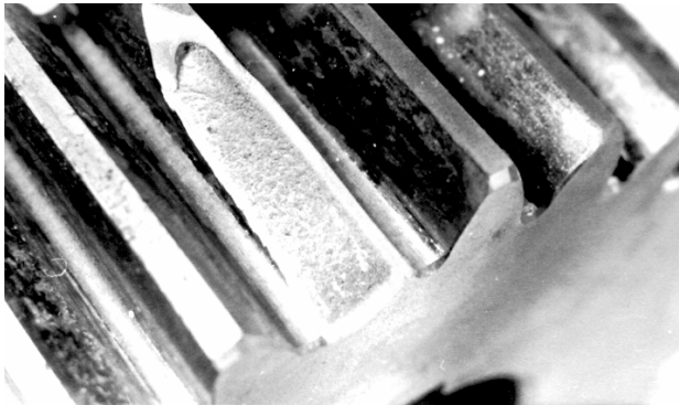
Bild 3.2.2 Zahnbruch am Endrad eines Getriebes beim statischen Bruchversuch Drehmoment beim schlagartig eintretenden Schaden etwa 11,5-faches Bemessungsmoment
