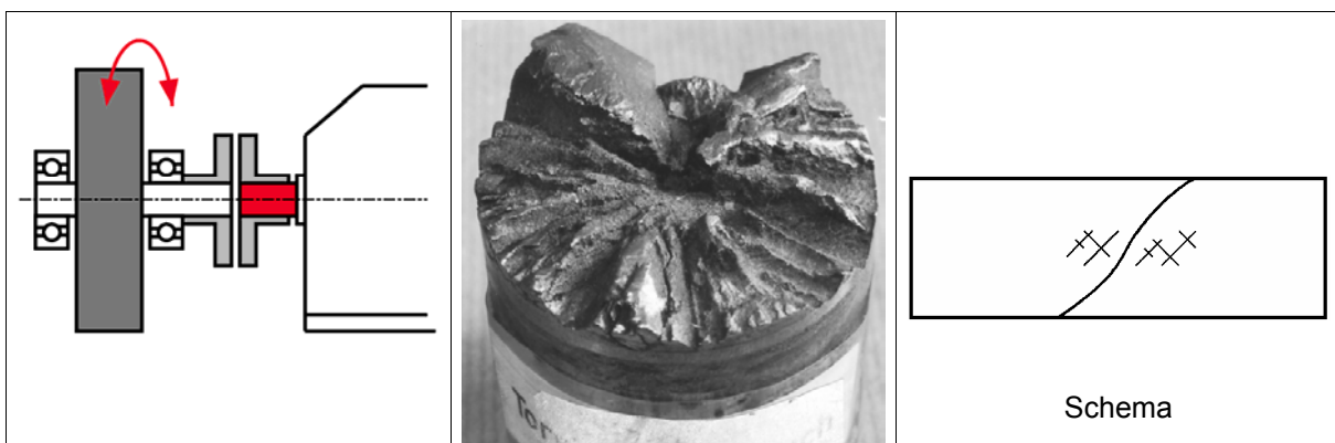
Bild 2.2.2 Anwendungsbeispiel Rollgangantrieb und Bruchbild bei Torsionsbeanspruchung in wechselnder Drehrichtung (Reversierbetrieb)
