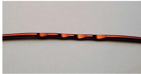
Bild 3.1.3 Extrembeanspruchung der Lackschicht durch Schläge mit der Hammerfinne
