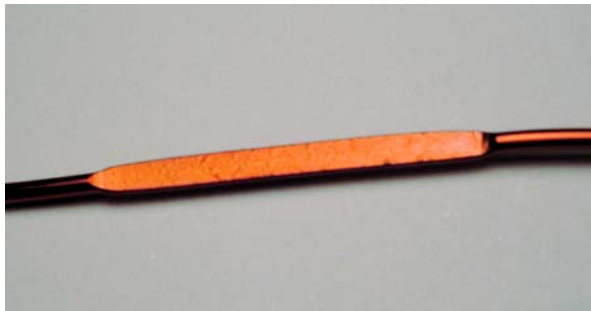
Bild 3.1.2 Extrembeanspruchung der Lackschicht durch Flachdrücken
