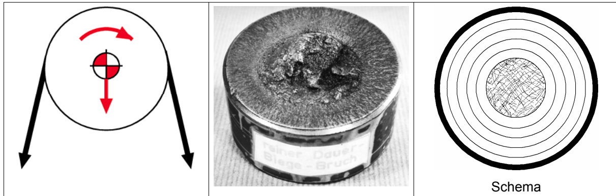
Bild 2.3.1 Anwendungsbeispiel Riementrieb mit Bruchbild bei Dauerbiegebeanspruchung mit unter der Last umlaufender Welle
