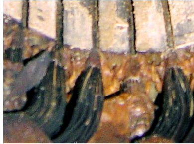
Bild 6.6 Folgen einer extremen, kurzzeitigen Überlastung, z.B. Stillstand mit festgebremstem Läufer
