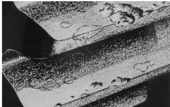
Abblätterungen (Spalling) als Folge von fehlerhaftem Werkstoff oder mangelhafter Wärmebehandlung bei der Einsatzhärtung
