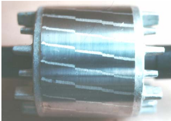
Bild 6.1 Versetztes Blechpaket (Fertigungsfehler)
