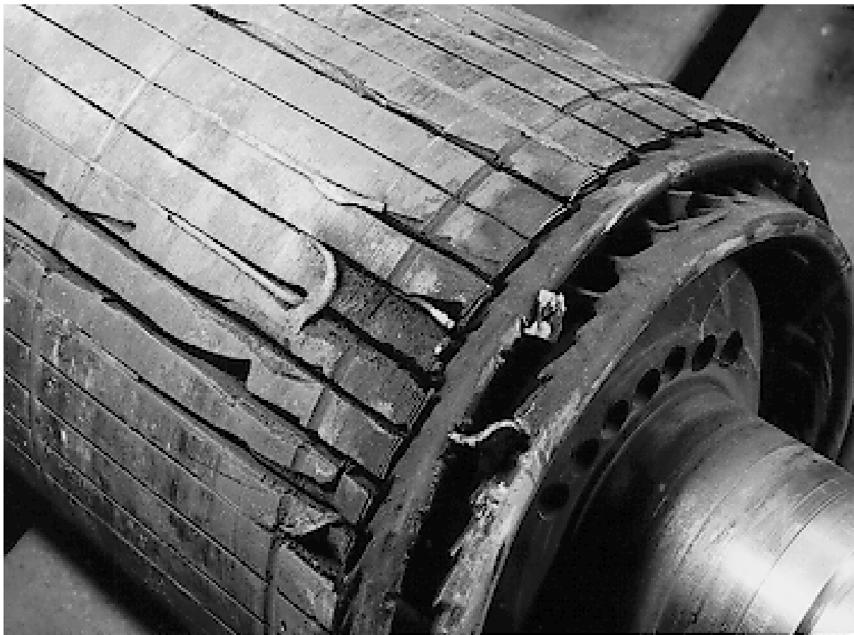
Bild 1 Folgeschaden an einem Doppelstab-Kupferläufer nach einem Lagerschaden
